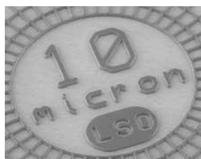
最先端基板向けのファインパターンに対応
