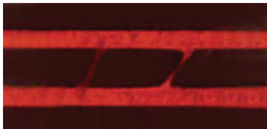
赤色光の画像 - ダストとファインショートは同じに見える
