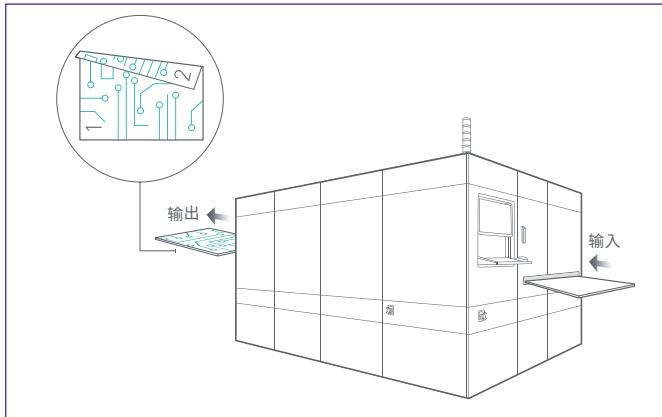
全自動，雙面直接成像解決方案，最大限度地提高了批量生產的產能和良率
