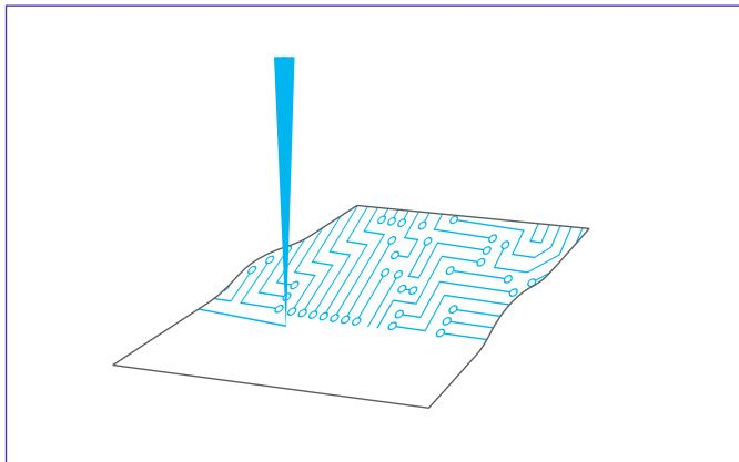
高景深 (DOF) 確保了在多種高低不均的板子上均能實現最佳的成像精度和均勻度
