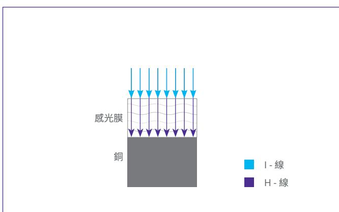
採用 KLA 經由市場驗證的 MultiWave Laser™ (多波長雷射) 技術兼容多種感光膜和製程
