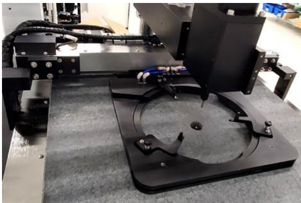
在非接触式空气轴承平台上进行非接触式双传感器晶圆测量
