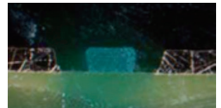
100μm 防焊桥基材上 40μm防焊厚度
