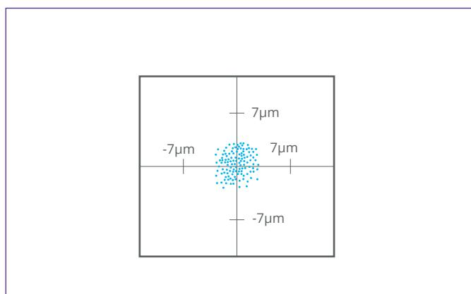
高阶应用对位精度可精确至  $\pm 7\mu\text{m}$
